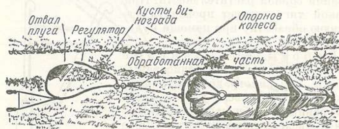
Рис. 99. Принцип действия плуга для работы в рядах кустов. Направляющая, встречая куст, заставляет корпус плуга сместиться вправо от рабочего. При этом он уклоняется от встречи с кустом. Незаштрихованная полоса обработана плугом, прошедшим по другой стороне ряда кустов.
